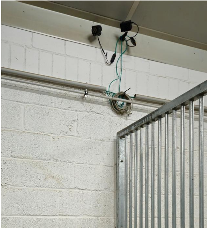
Abbildung 3: Anbringung des KI-Kamerasystems HORSE PROTECTOR der Firma ACARiS in der Box. ©Leonie Teschke
