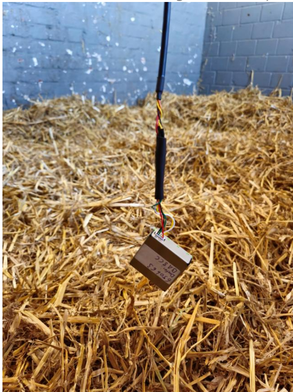
Abb 1: Sensorgestützte Messung der Feinstaubbelastung in der Pferdebox. ©Leonie Teschke
